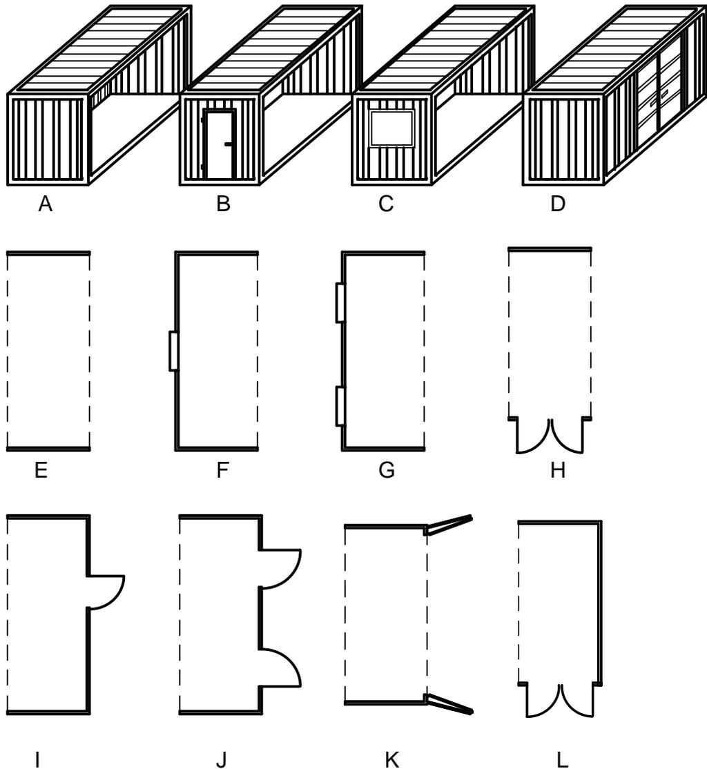
**Typen C, F, G:** 1 bzw. 2 Fenster, 800x1200 mm, feststehend, stab. Rahmen a. Quadratrohr 50x50 mm, VSG 8
